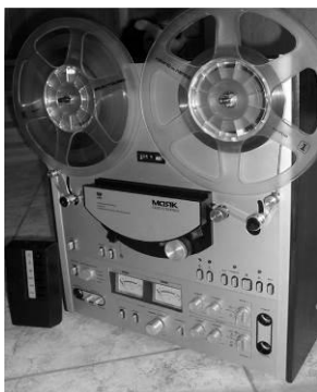
Рис. 2. Котушковий стереофонічний магніфон-приставка вищого класу «Маяк – 005 стерео» (дослідна модель 1982 року)
